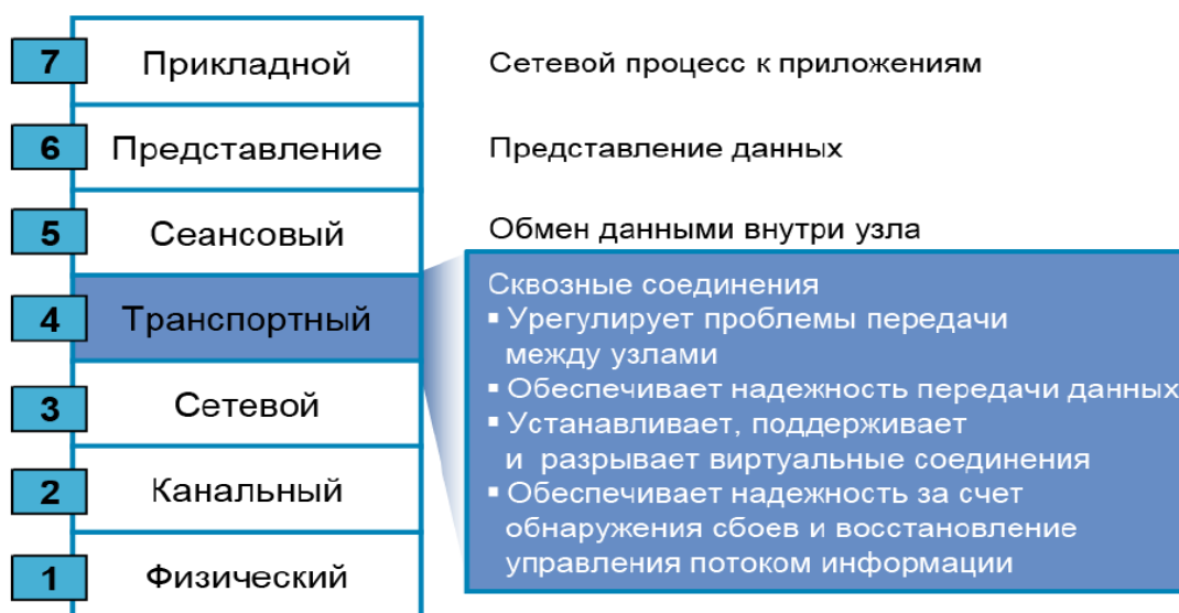
Рисунок 5 –Транспортный уровень модели OSI
