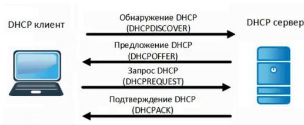
Рисунок 4 - Принципы работы протокола DHCP
