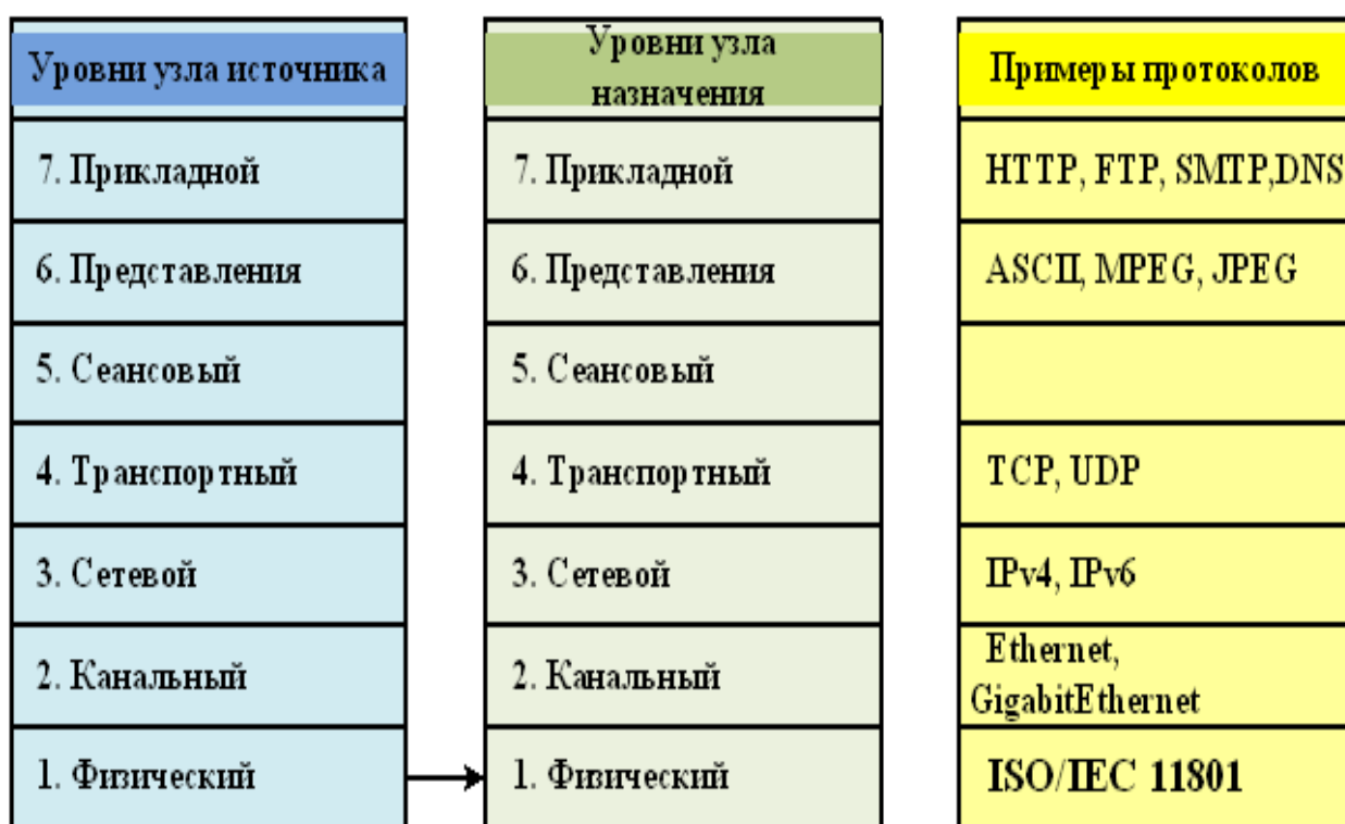
Рисунок 1 - Семиуровневая модель OSI
